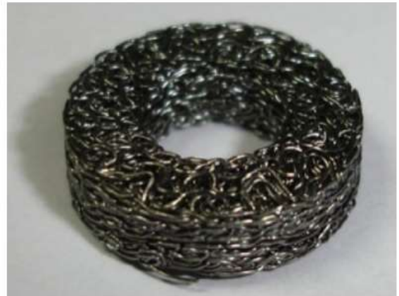
Рис. 9. Сітчаста шайба із сплаву пам'яті псевдопружної форми
