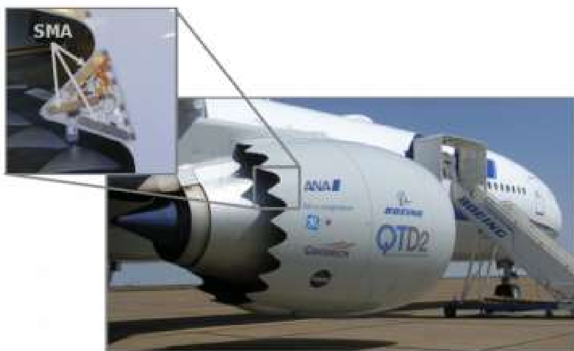
Рис. 7. Шеврон з технологією зміни форми
