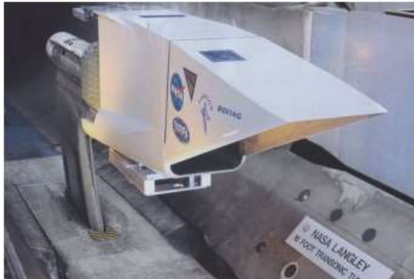
Рис. 5. Повітрозабірник F-15, протестований на об'єкті «NASA Langley»
