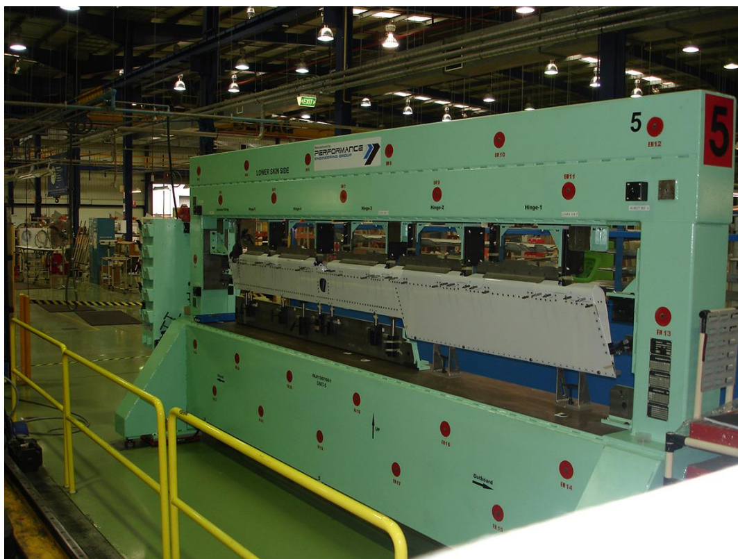
Рисунок 2.7 – СП для складання елеронів Boeing 737
