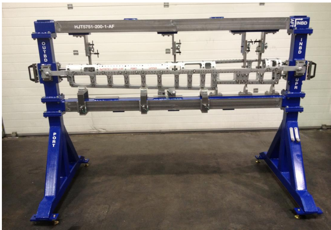
Рисунок 2.8 – СП для складання елеронів фірми LSNW
