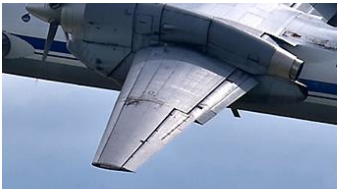
Рисунок 1.1 – Елерони лівої консолі крила Ан-32
