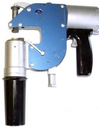
Рисунок 2.6 – Машина клепально-розкатного типу МКР
