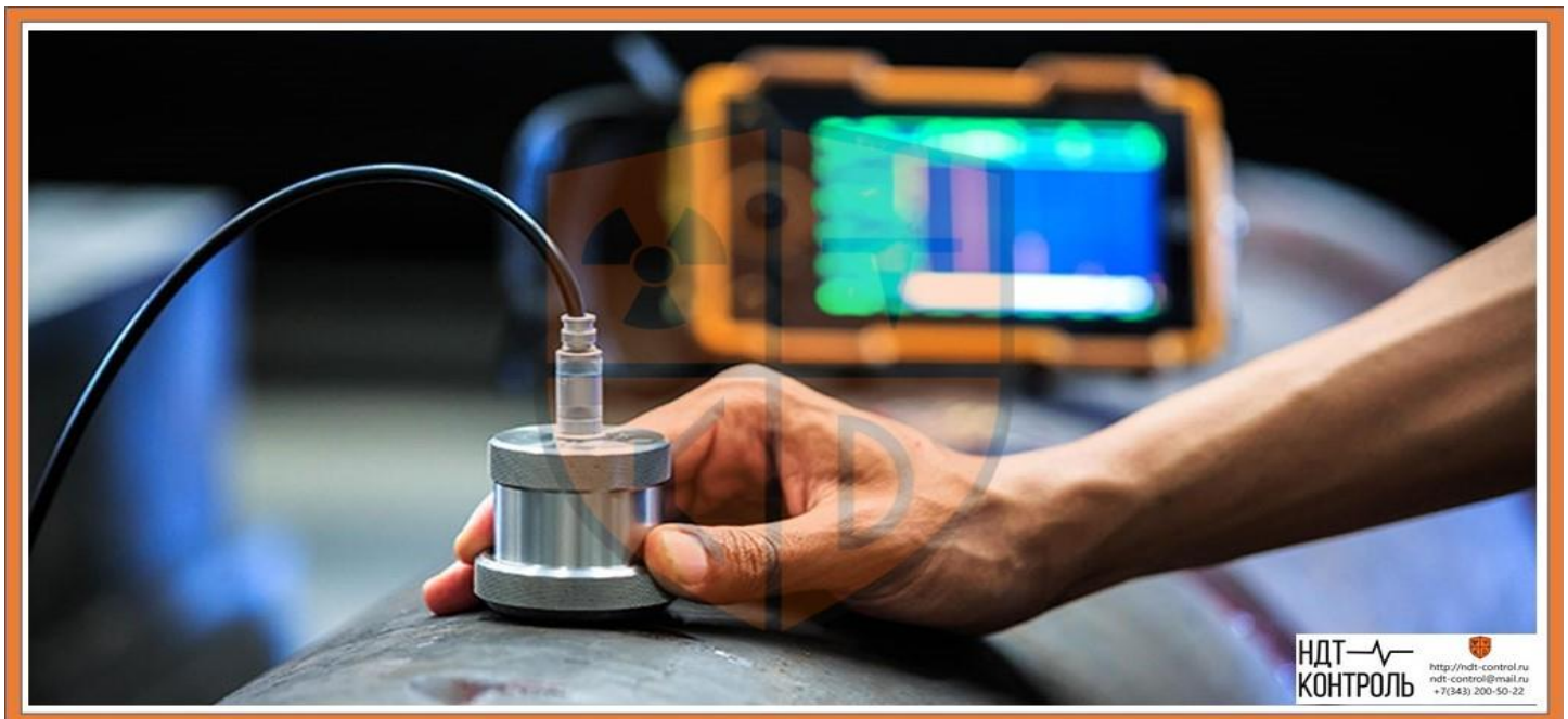
Рис.4.1 Принцип проведення контролю і вимірювань за допомогою ультразвукового імпульсного методу.
