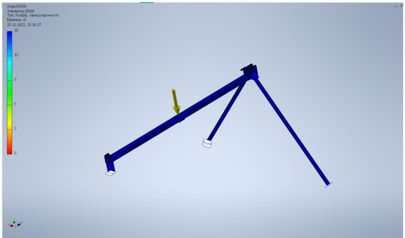
Рис 6.6. Розрахункова епюра коефіцієнту запасу міцності
