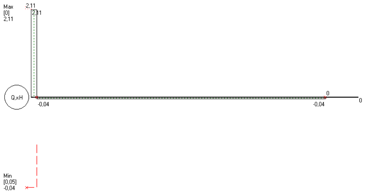
Рис. 4.2. Епюра поперечних сил [кН]
