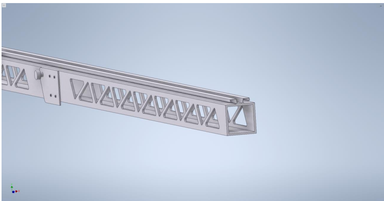
Рис 5.1. Просторова модель направляючої та рейки
