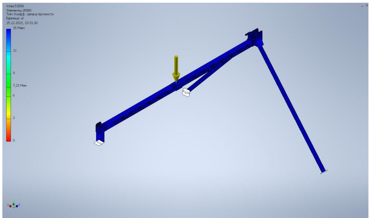
Рис 6.3. Розрахункова епюра коефіцієнту запасу міцності
