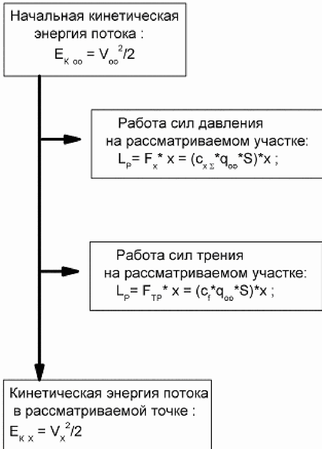
Рис. 2.3. Схема витрачання кінетичної енергії при адіабатичному русі частинки на даній ділянці.
