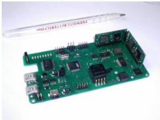
**Рисунок 1. Интегрированная миниБИНС**
