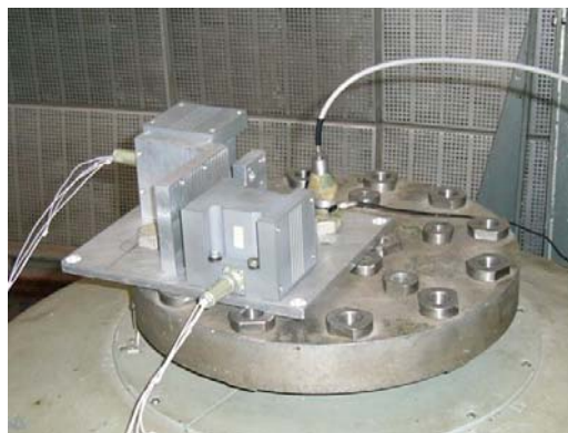
Рис.2.1. CVG25-178 и CVG25-185 на платформе ударного стенда для испытаний вдоль OY CVG25-178 и оси, перпендикулярной OY для CVG25-185.
