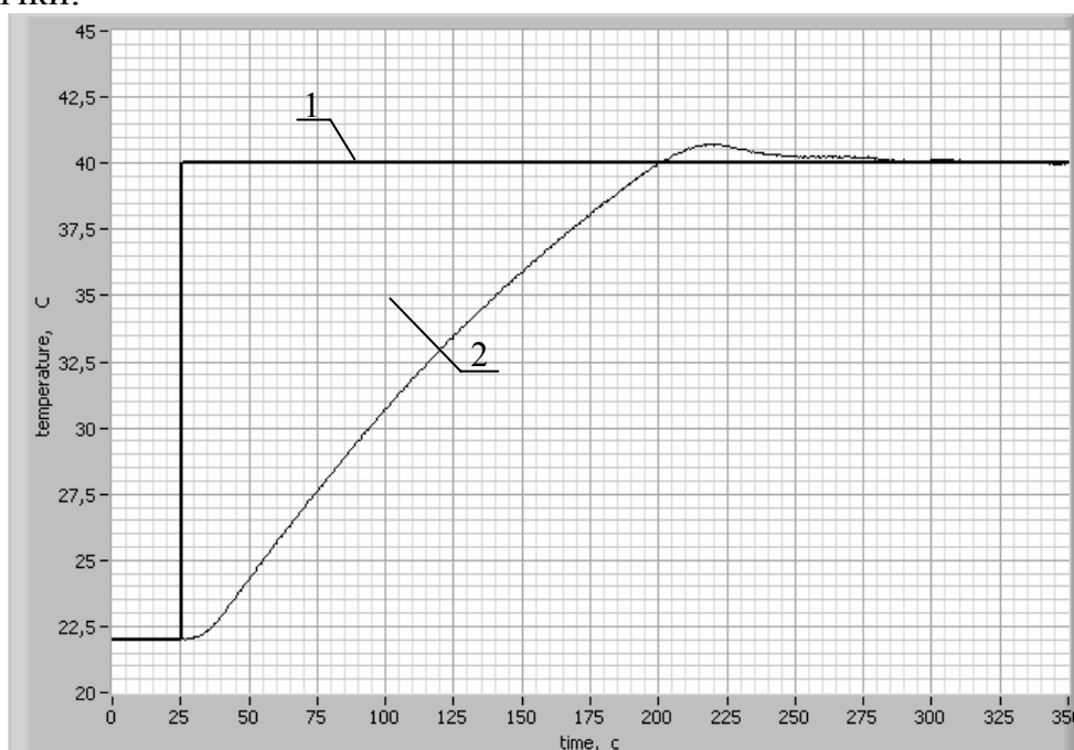
Рис.4. Результат роботи регулятора на основі нечіткої логіки. 1 – “опорна”, 2 – діюча температура.
