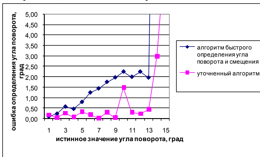
Рисунок 2.2 – Зависимость ошибки определения угла поворота для быстрого алгоритма.
