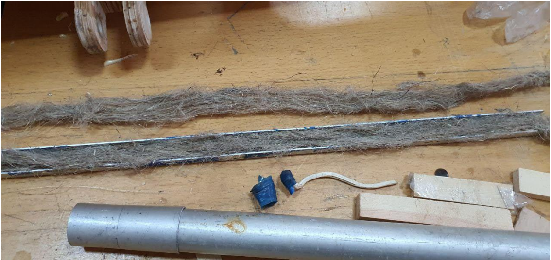
Рис.5.1 Випрямлені волокна канабісу
