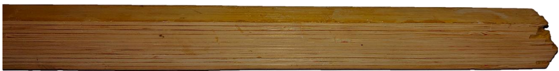
Рис.2.2 Клеєний бамбуковий брус з 12 планок. Висота 26 мм, ширина 18 мм.
