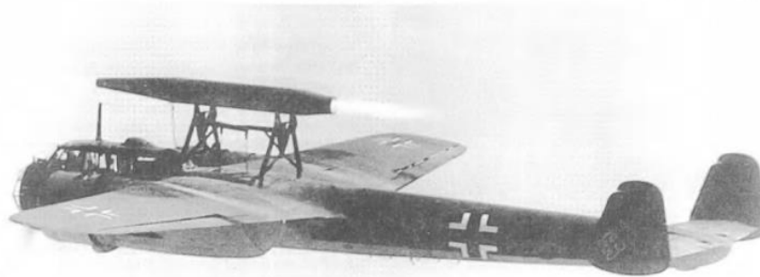
Рис. 8 Літак Дорн'є Do 17 Z, випробувальний політ з 500-мм ППРД Зенгера. [14]
