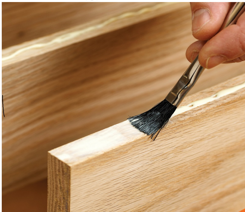
Рис.9.1 Нанесення клею на заготовку для подальшої збірки
