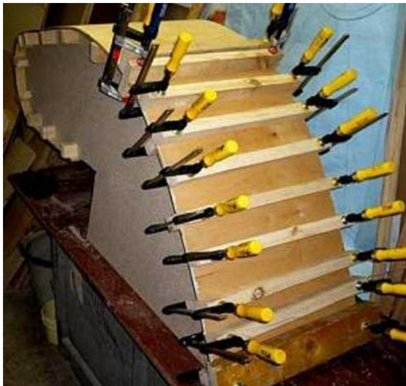
Рис.9.3 Згин фанерного листа закріпленого струбцинами
