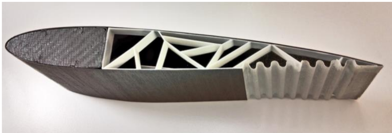
Рис. 1.2.3. Секція адаптивного крила «Smart airfoil»
