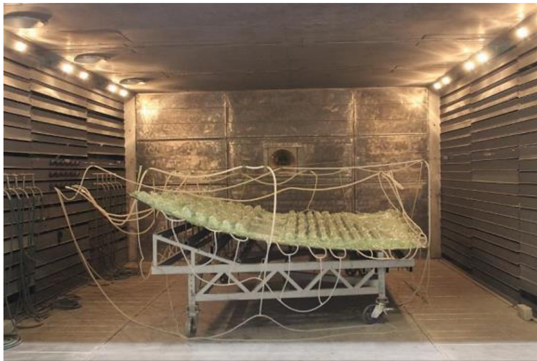
Рис. 6.3. Елемент крила у вакуумному мішку
