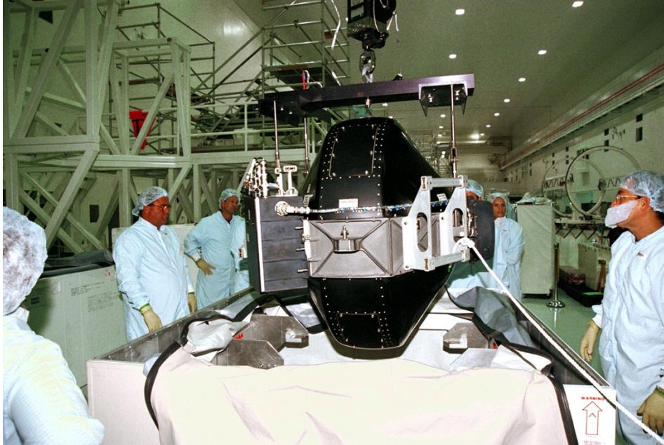
Рис. 1.3. Технічний персонал Боїнга готує гіродін CMG-1 для екіпажу STS-93, який встановить його на ферму Z1 Міжнародної космічної станції. [5]
