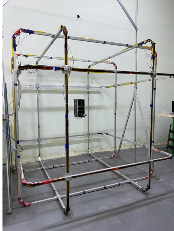
Рис 3.10. Наносупутник PolyTAN-2 на підвісі стенду-імітатору магнітного поля
