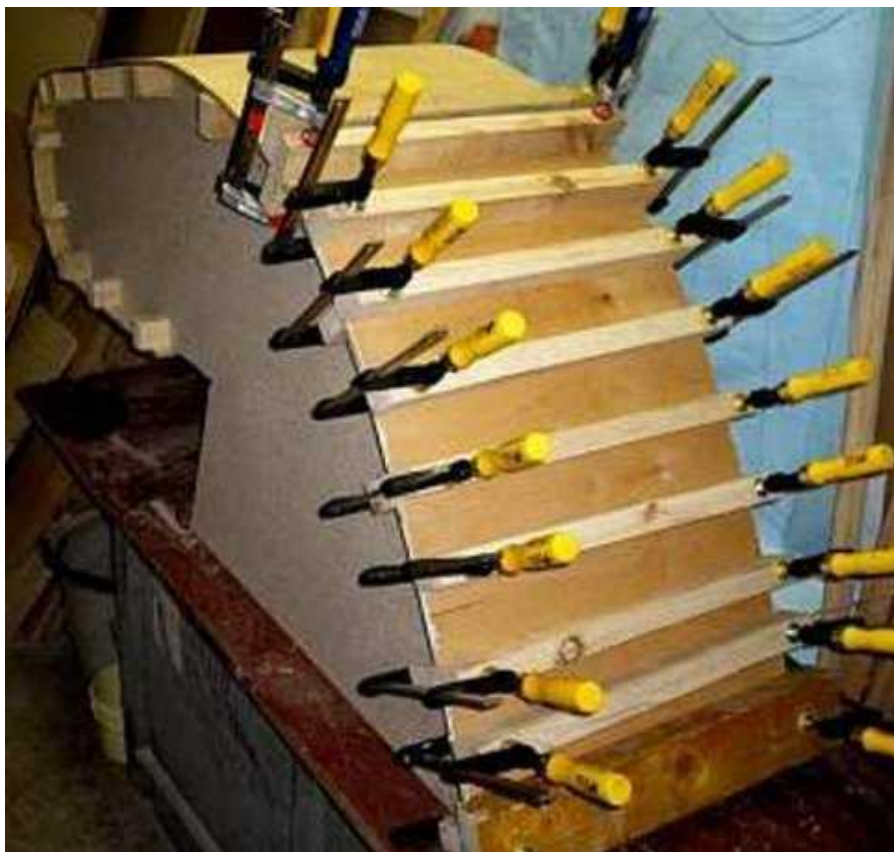
Рис. 9.1 Метод гнуття мокрої фанери
