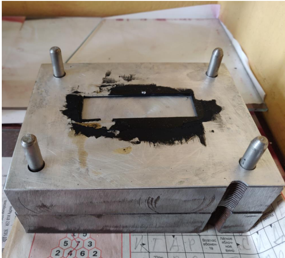
Рис. 3.4. Форма для виготовлення пластин із товщиною в 1.8 мм.
