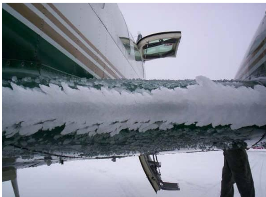
Рис. 1.1. – Утворення льоду на передній кромці літака.
