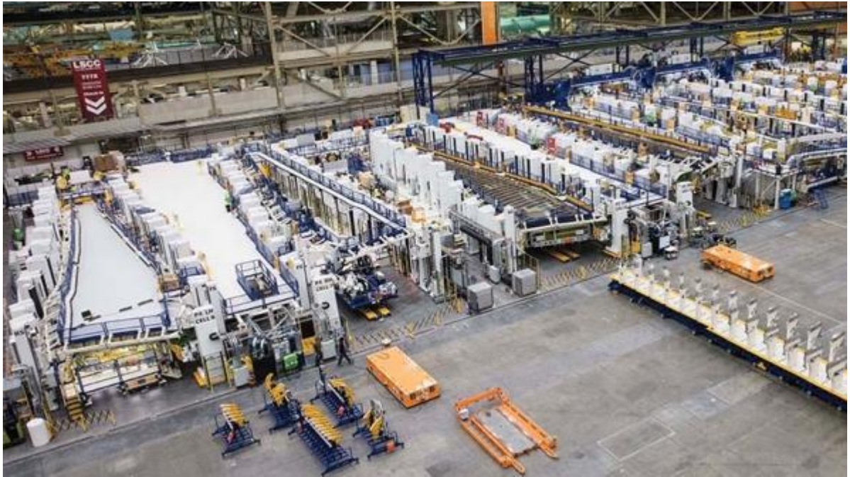
Рисунок 4.13 – Лінія стендів позаетапельного складання консолей крила літаків B777 (фото – https://aviationweek.auth0.com/login?state )
