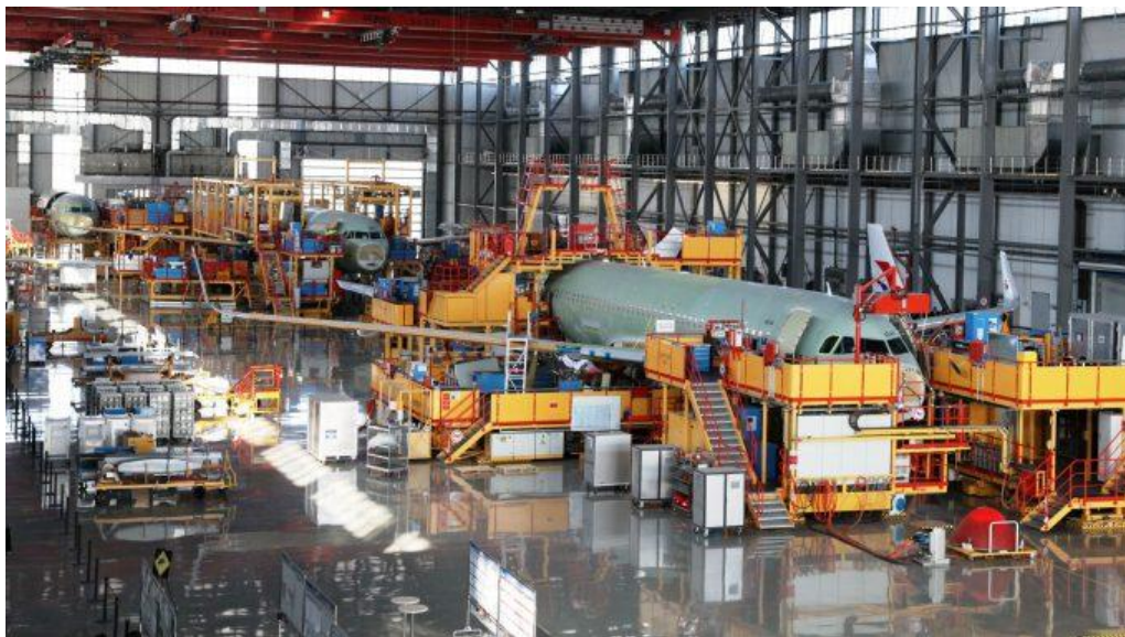
Рисунок 4.12 – Лінія кінцевого складання літаків марки Airbus (фото – https://www.ifn.news/posts/airbus-temporarily-closes-final-assembly-line-in-china/ )
