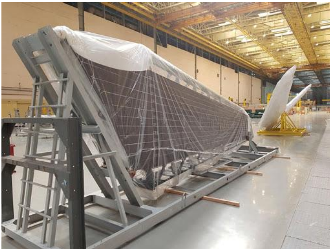
Рисунок 4.9 – Модульне пристосування для складання кіля (фото - http://www.up-pro.ru/library/logistics/transport/Gibkaya-bronya.html )
