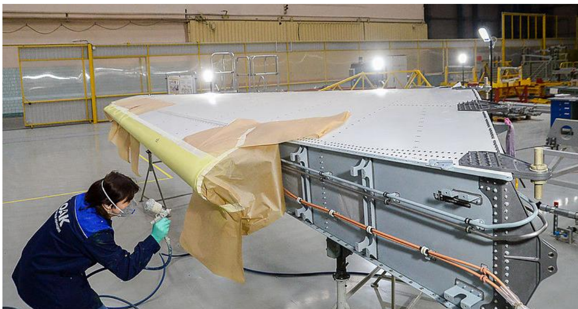
Рисунок 4.10 – Стенд позастапельного складання кіля літака МС-21
