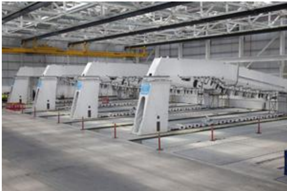
Рисунок 4.14 – Лінія стапелів складання крил літаків Bombardier CSeries (фото – https://skiesmag.com/press-releases/new-bombardier-cseries-aircraft-wing-factory-taking-shape-with-installation-of-assembly-jigs-html/ )
