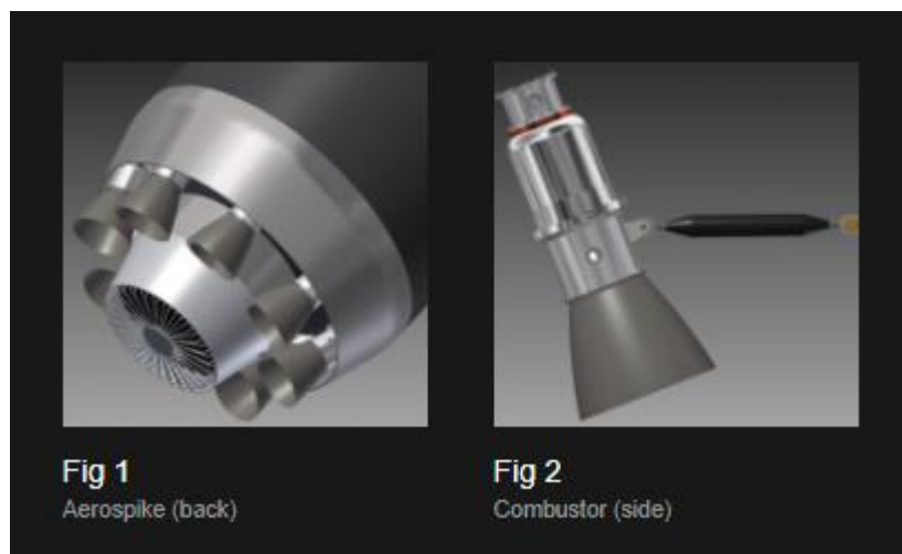
Рис. 2.2.2. Клиноповітряний ракетний двигун (зліва) та його камера згоряння (справа)
