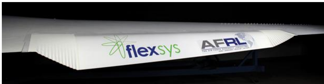
Рис. 1.7. Зовнішній вигляд фрагмента адаптивного крила з обшивкою
