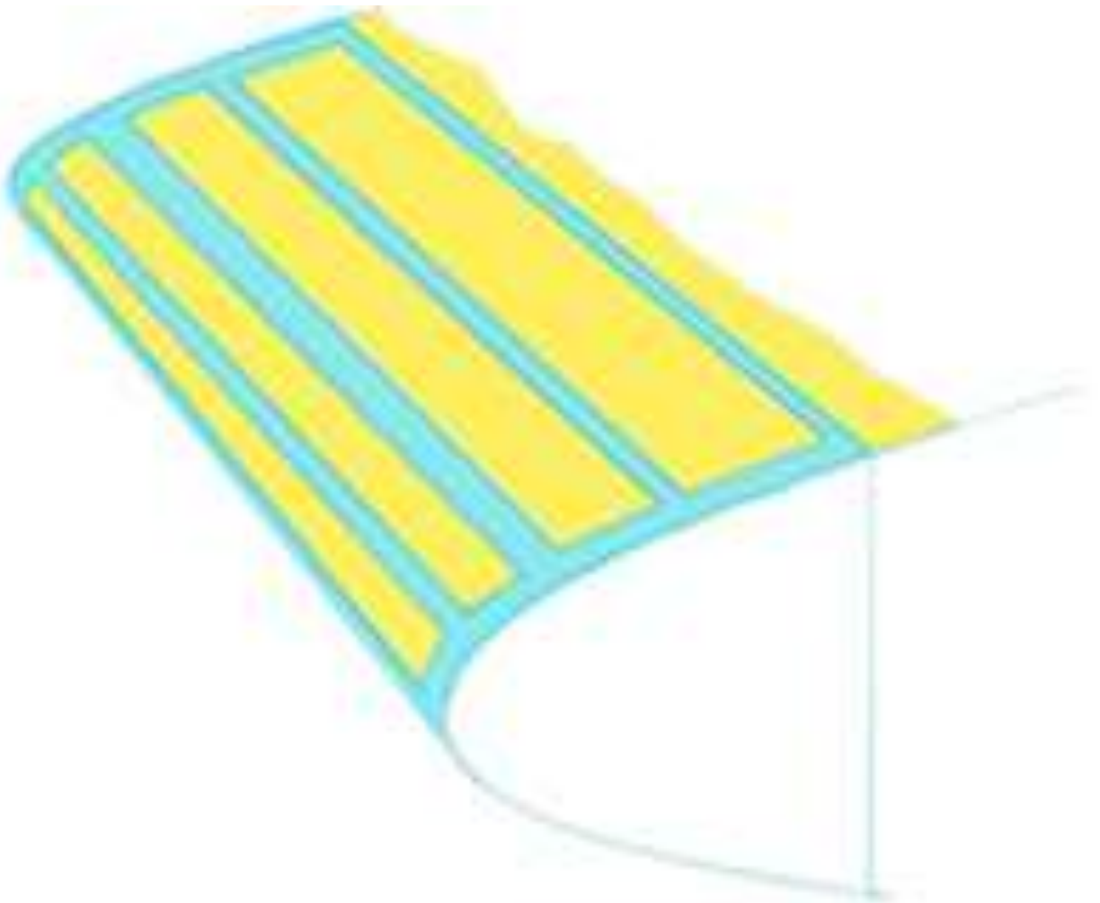
Рис.3.3. Установка трафарету на вже нанесений шар діелектрика
