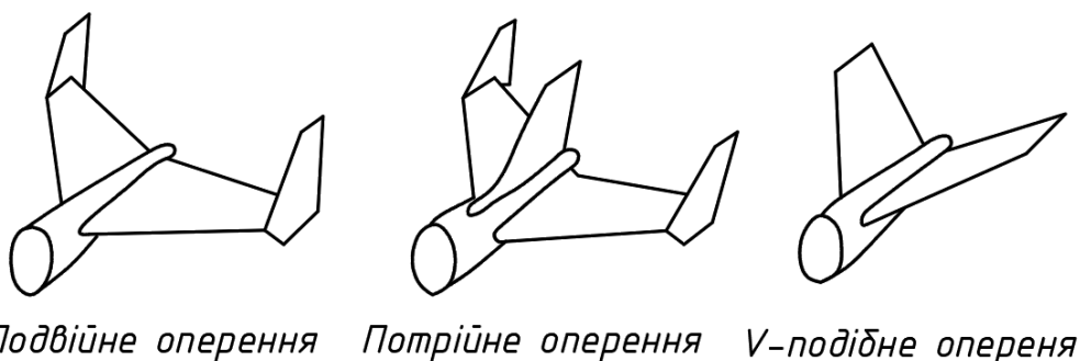
Рис.1.2. Схема оперення з декількома вертикальними стабілізаторами.
