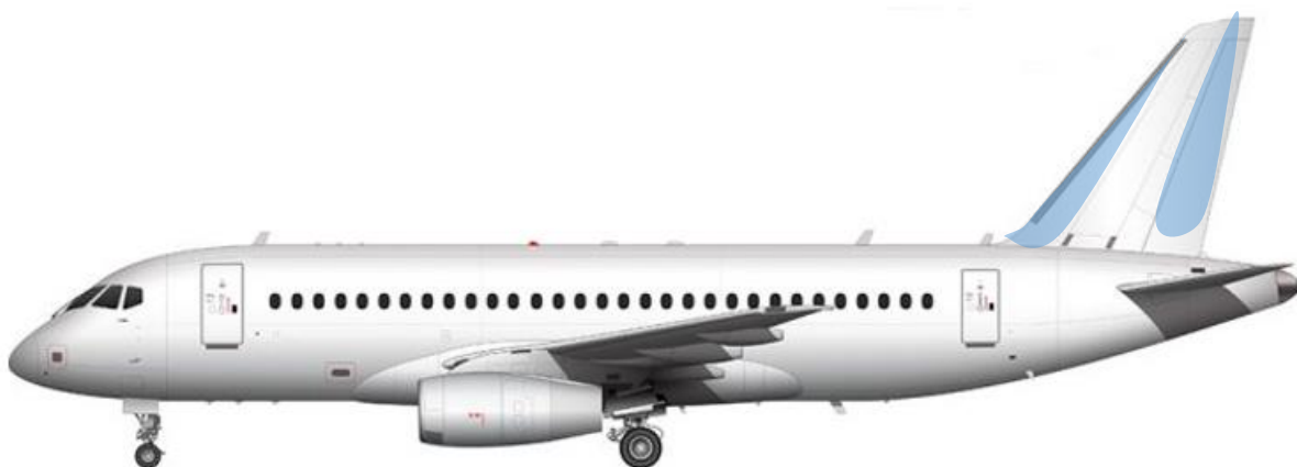
Рис.1.1.2. Літака Sukhoi Superjet 100, синім виділені композитні панелі в кілі.
