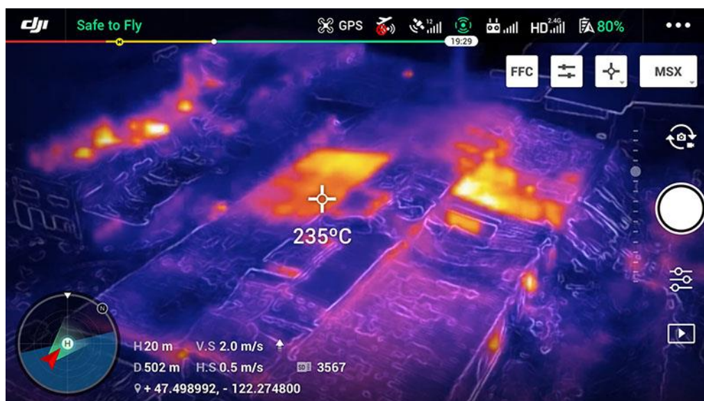
Рис.1.2.1 Визначення вогнища загоряння за допомогою тепловізора Льотно-технічні характеристики БПЛА «DJI Mavic 2 Enterprise Dual»
