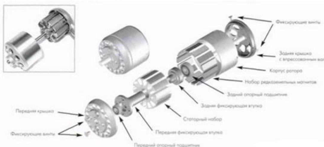
Рис 3.2. схема бесколекторного двигуна
