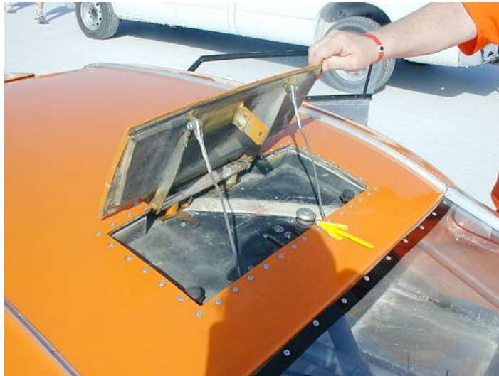
Рис.10 Загальний вигляд Roof Flaps
