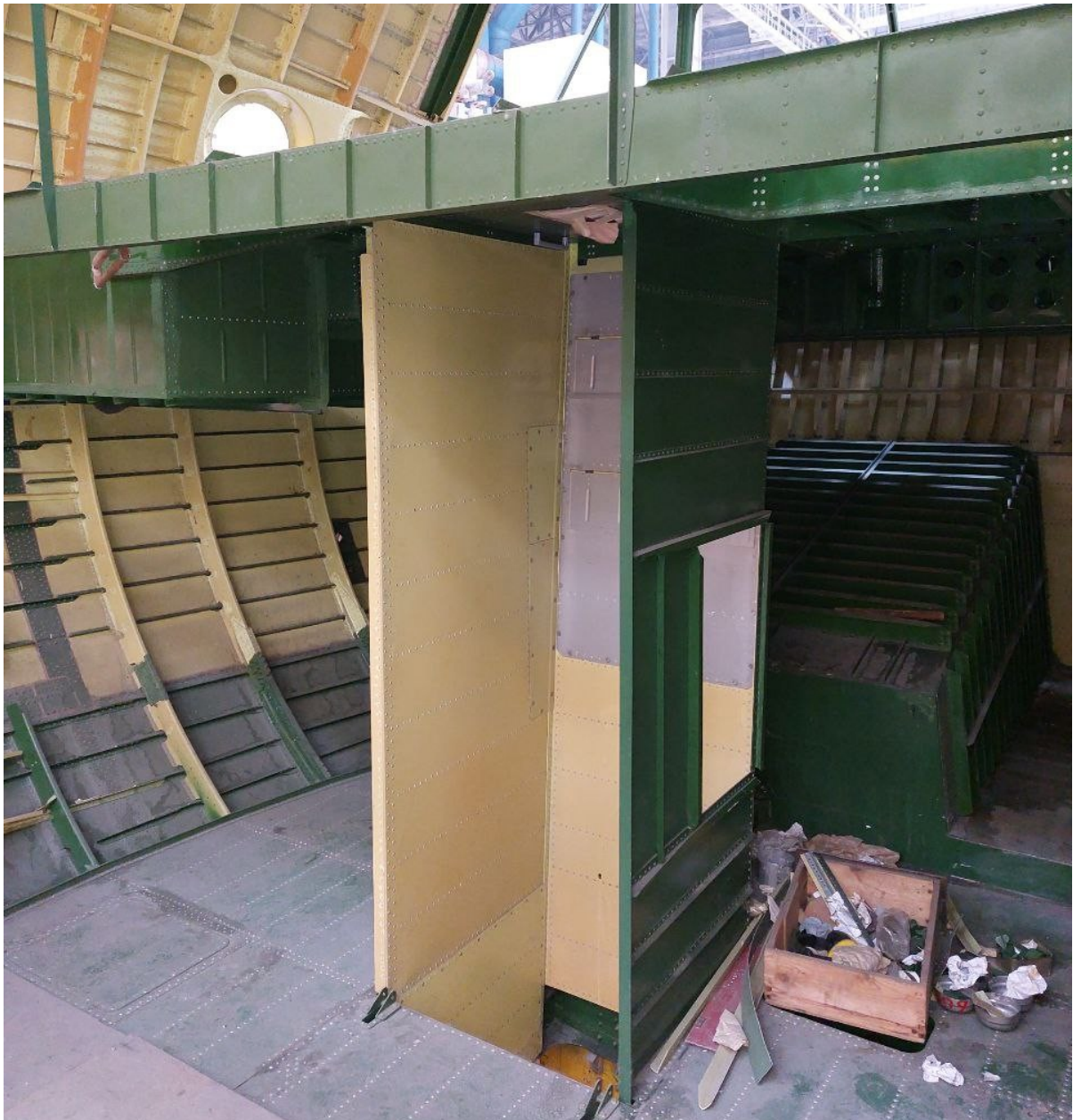
Рис.1.1 Шахта аварійного покидання транспортного літака АН-70
