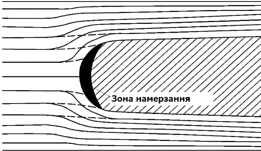
Рисунок 3.3 – Схема обтікання тіла потоком повітря, що містить краплі води.
