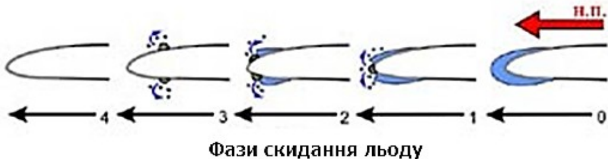
Рисунок 1.2 – Принцип дії пневматичної ПС
