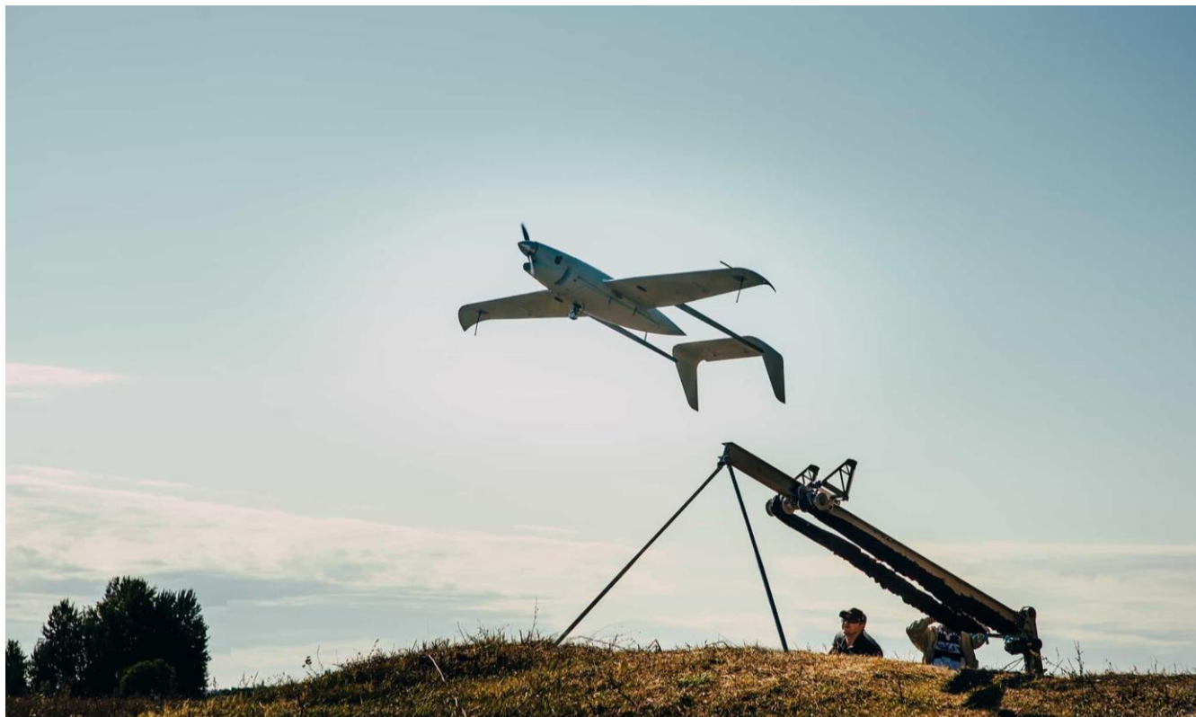
Рис. 1.4 Raybird-3 запуск з пускової установки
