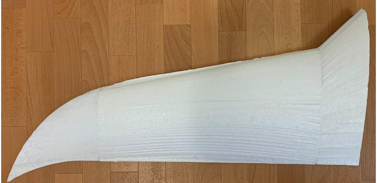
Рис.4.4 Виготовлена пінопластова консоль крила
