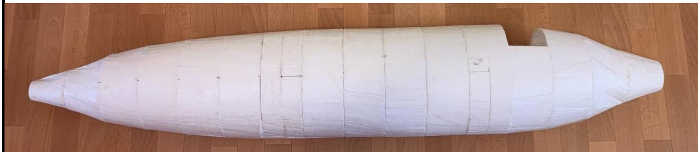
Рис.4.4 Виготовлений пінопластовий фюзеляж
