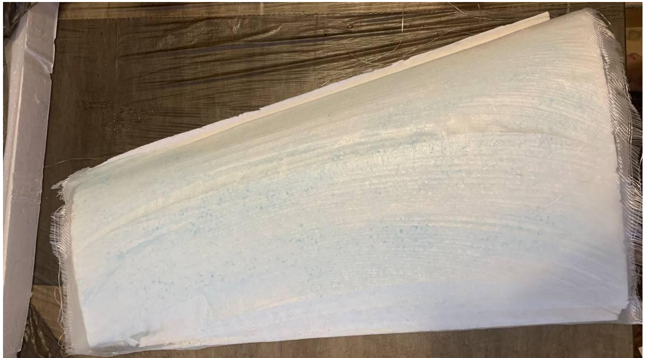
Рис.4.6 Частина крита після виклейки
