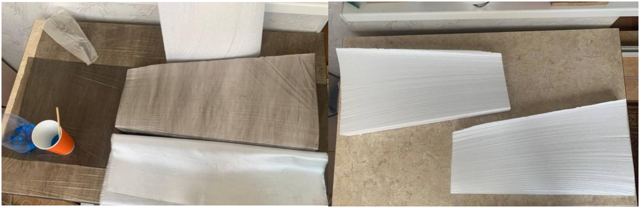
Рис.4.5 Залишки пінопласту, що покращують прилягання склотканини
