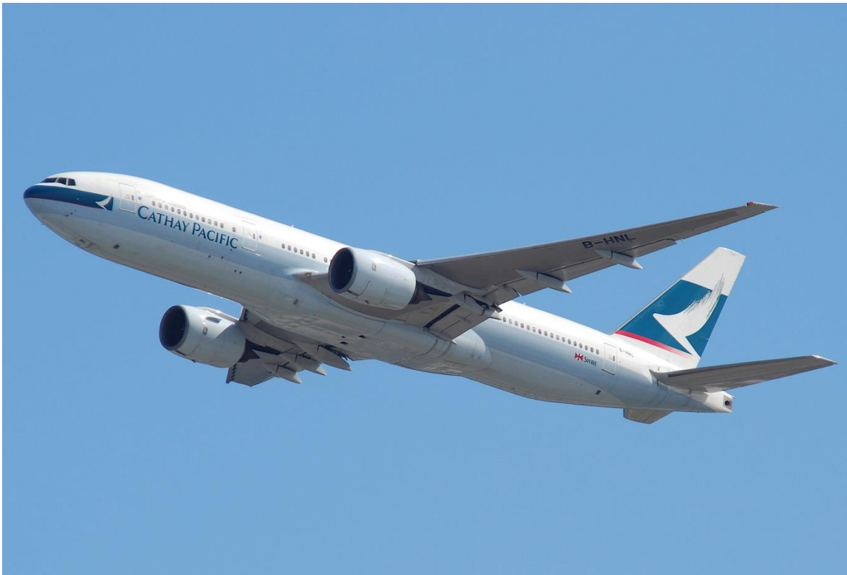
Рис. 4 Boeing 777, літак з ТРДД GE90
