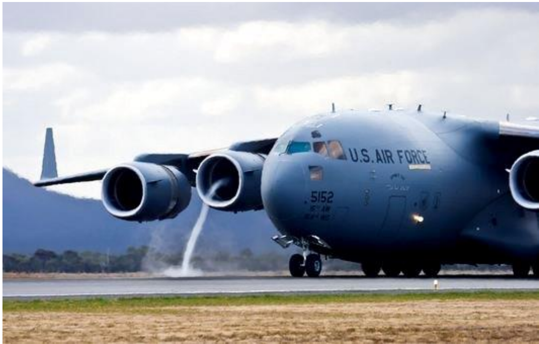
Рис. 38 Вихор, що виник під час роботи двигуна при великих обертах поблизу землі і при близькій до нуля швидкості руху літака
