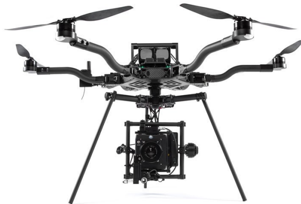
Рисунок 2.2 – Мультикоптер Freefly Alta 6 з встановленою камерою та системою стабілізації
