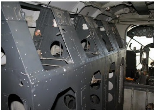
Рисунок 1.1 – Бомбовий відсік бомбардувальника Heinkel He-111
