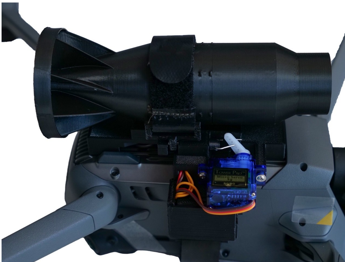
Рисунок 2.6 – Один з варіантів реалізації конструкції системи скидання зробленої методом 3D друку.
