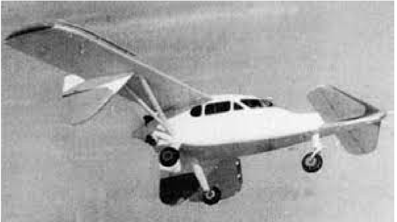
рис. 2.2 МиГ-8 - схема “качка”
