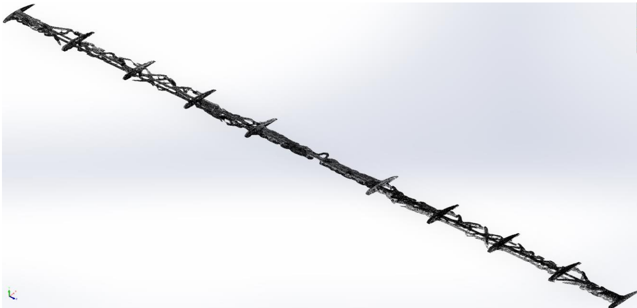
Рис. 3.12. Конструкція крила отримана з застосуванням топологічної оптимізації.
