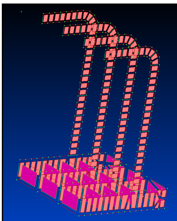
Рис.6.1.3. Структура СЕМ набору відсіку фюзелжу
