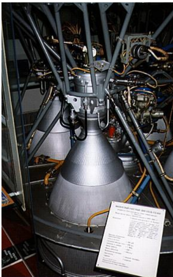
Рис.5.4 Двигун РД-0110, що є аналогом для двигуна першої ступені.
