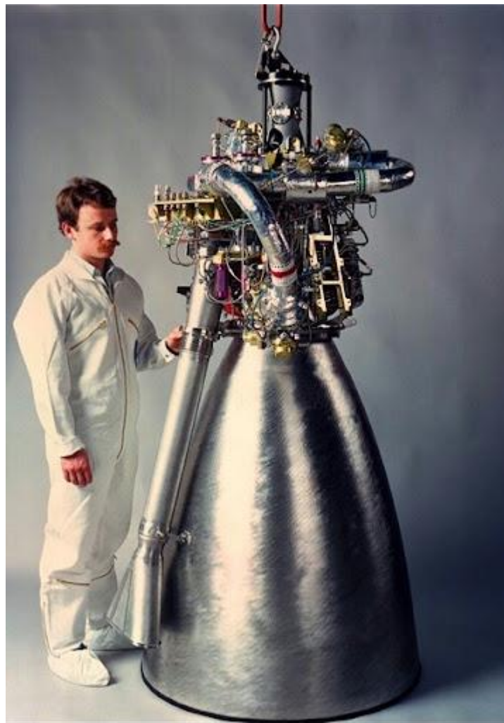
Рис.5.5 Двигун НМ7В, що є аналогом для двигуна другої ступені.
