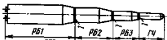
Рис. 2.1 Компонівна схема «тандем»
