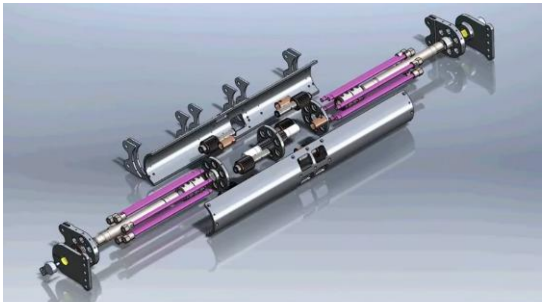
Рис. 1.5. Шарнiр та актуатор механiзму повороту адаптивного крила Spanwise Adaptive Wing
