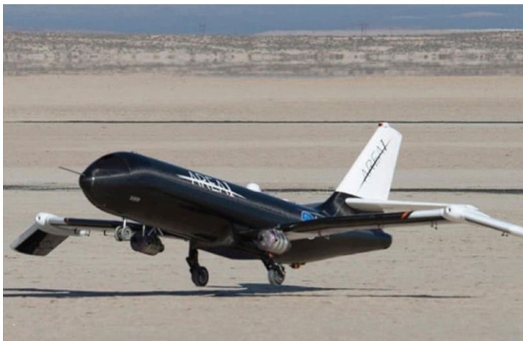
Рис. 1.4. Льотні випробування Spanwise Adaptive Wing
