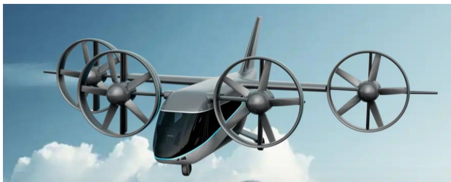
Рис. 1.2 Використання імпелерів у конвертоплані у моделі Bell Nexus
