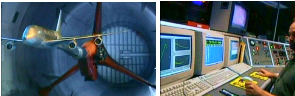
Рис. 2.15. Дренажна модель в аеродинамічній трубі.
