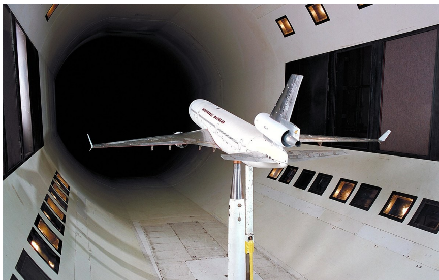
Рис. 4.1. Аеродинамічна труба NASA.
