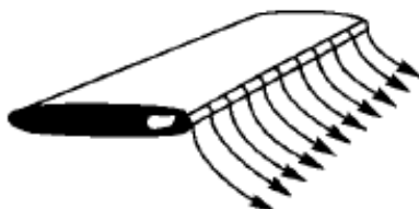
Рис. 3. Видув струменя на заокруглену задню кромку крила
