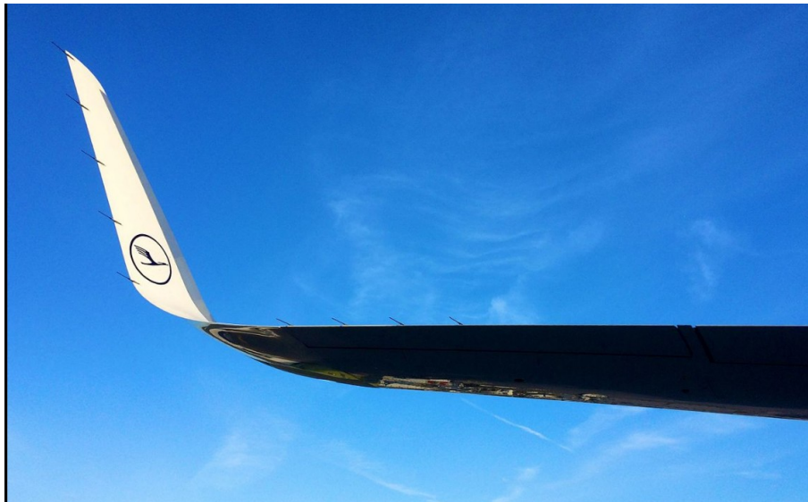
Рис. 2.1.3 Спряжений вінглет на літаку Airbus A320
