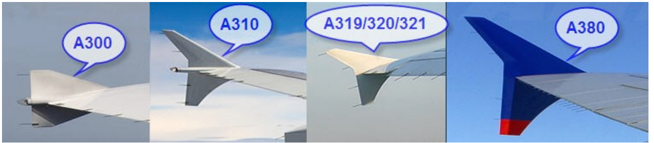
Рис. 2.1.1 Вінглетна загорожа на різних літаках компанії Airbus
