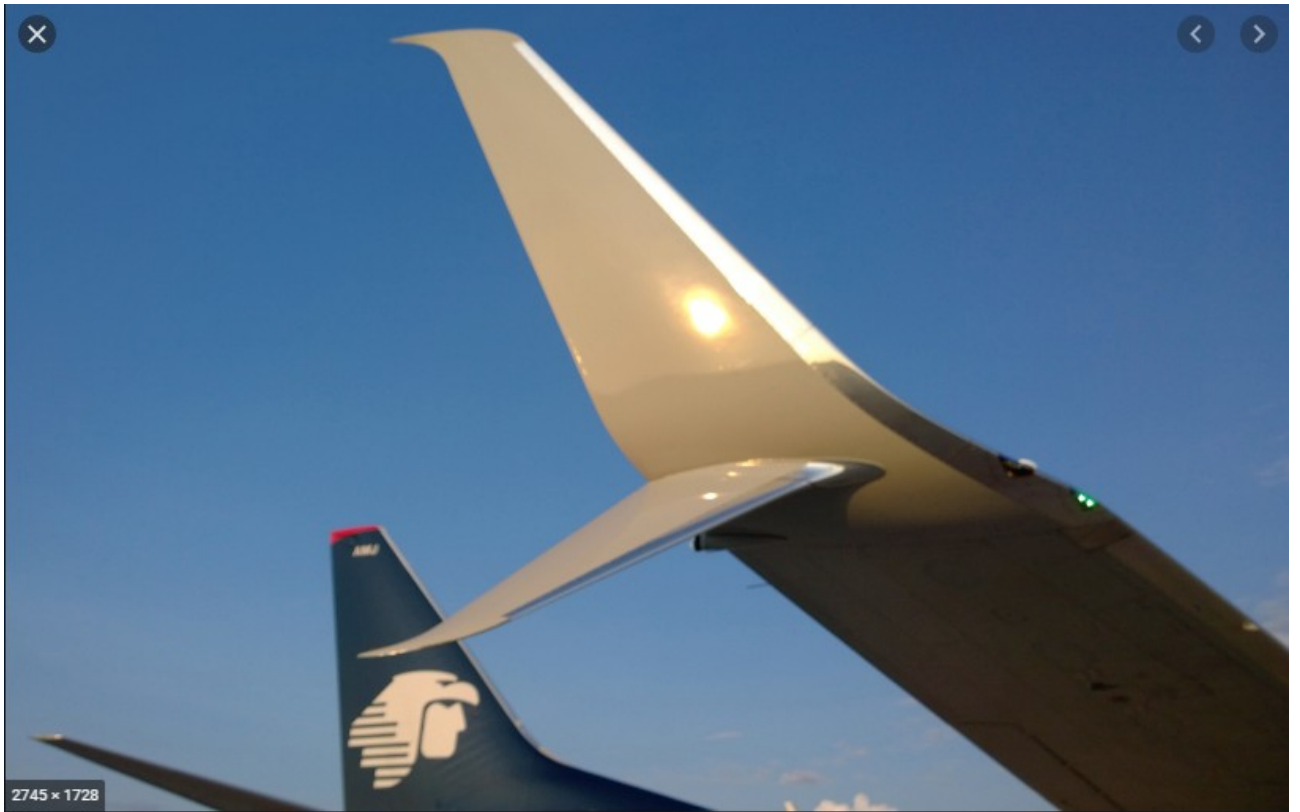
Рис. 2.1.5 Роздвоєна закінцівка на літаку Boeing 737 MAX
