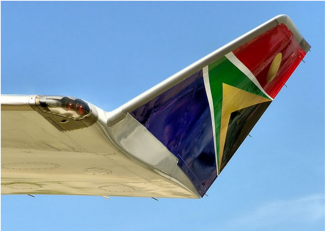
Рис. 2.1.2 Нахилений вінглет на літаку Boeing 747-400
