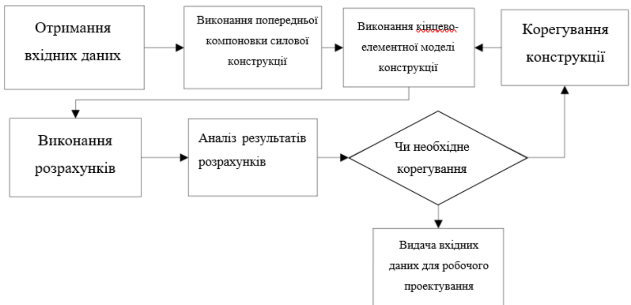
Рис.1.2.2: Процес проектування конструкції з ПКМ.
