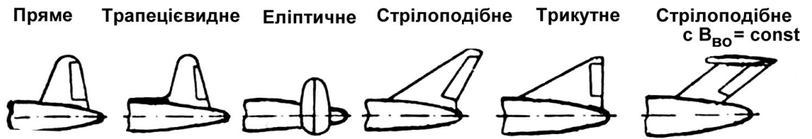
Рис. 2.10. Форми вертикального оперення при вигляді збоку.
