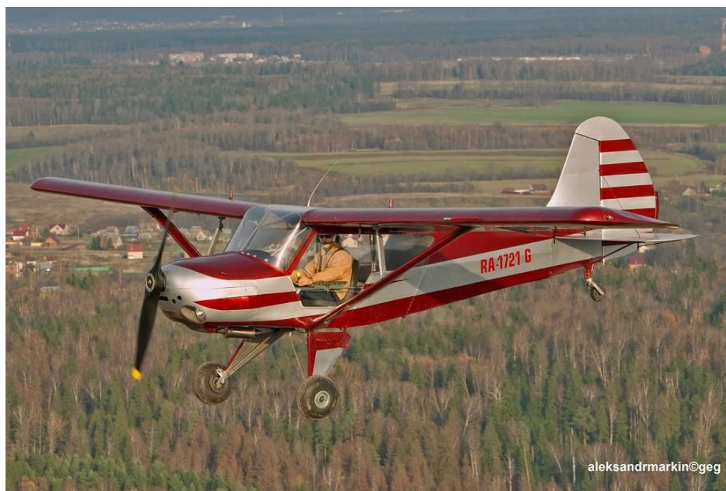
Рис.2.12. Літак з трьохопорним шасі з хвостовим розміщенням опори
