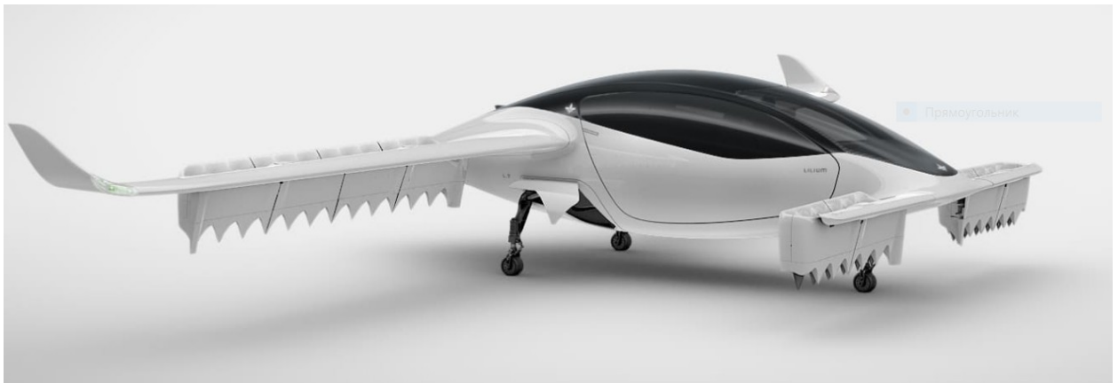
Рис.1.1.1. Конфігурація для вертикального злету-посадки
