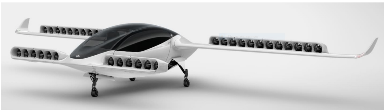
Рис.1.1.2. Конфігурація ЛА для горизонтального польоту
