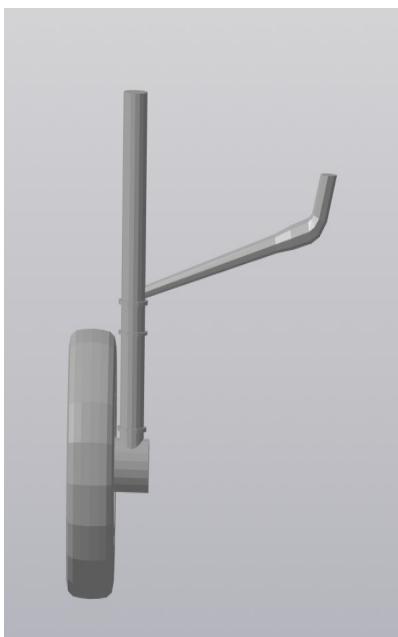
Рис. 15. Побудова основної стійки шасі з підкосом
