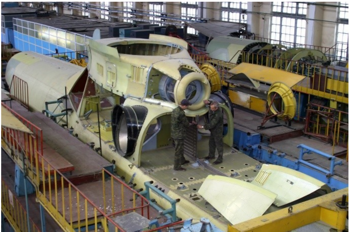
Рисунок 15 – Відсік Ф-2 вертольота Мі-26.
