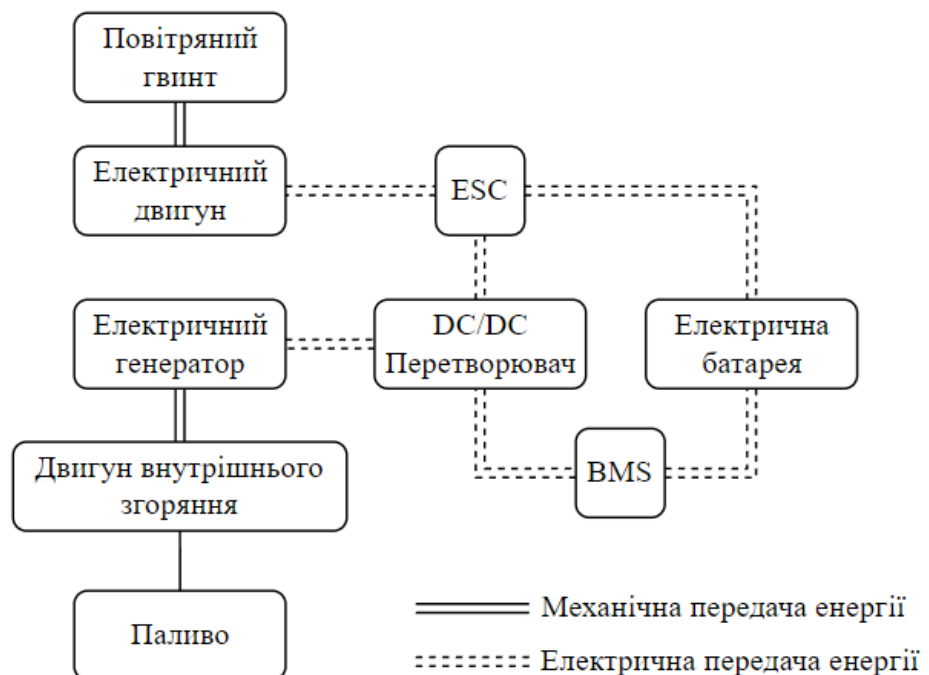
Рис. 6. Схема послідовної гібридної конфігурації.
