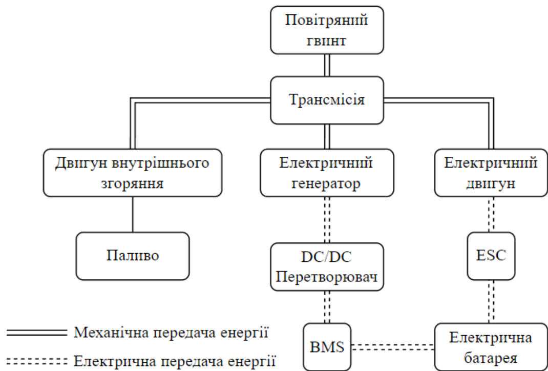
Рис. 9. Схема комбінованої гібридної конфігурації.
