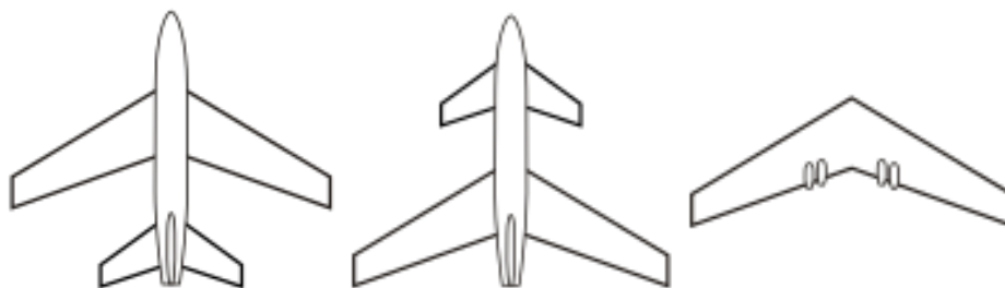
а) Нормальна схема б) Схема «качка» в) Літаюче крило
