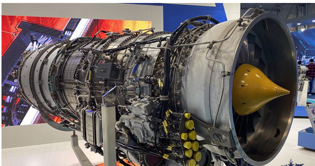
Рисунок 3.1 Турбореактивний двоконтурний двигун АІ-25ТЛТ
