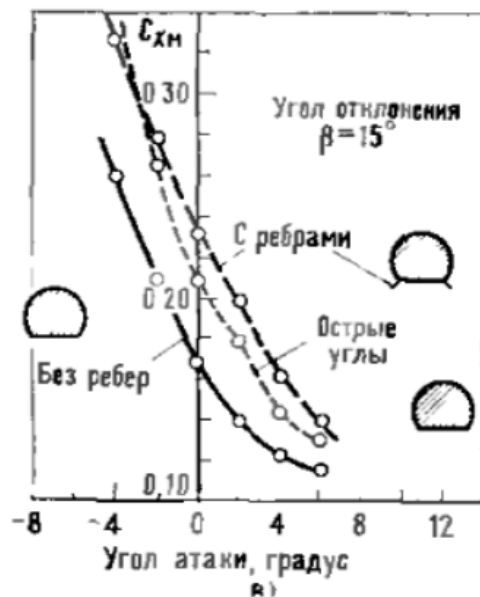
Рис. 3.13 Вплив несиметричності хвостової частини фюзеляжа на аеродинамічний опір
