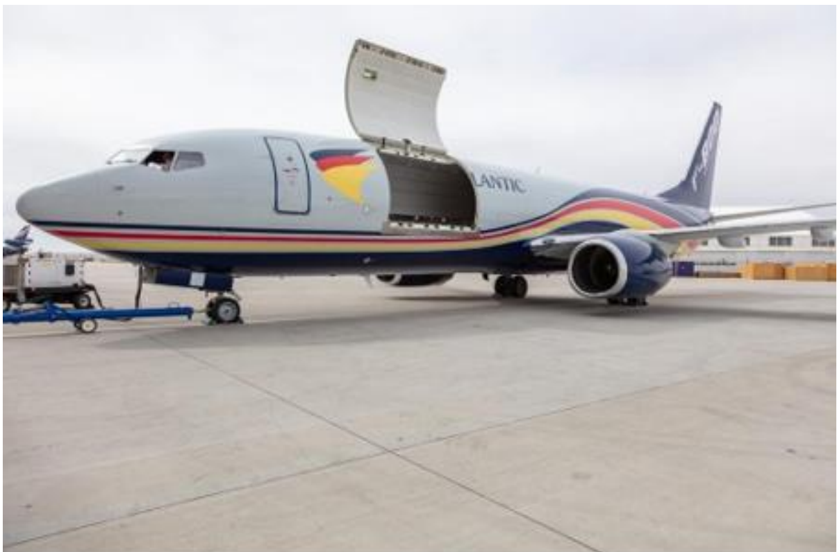
Рис 1.4.2. Відкритий вантажний люк літака B737-800BCF.
