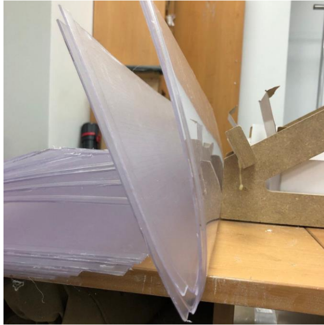
Рис.6.4 – гнучий та додатково термічно оброблений термопласт PVC-P
