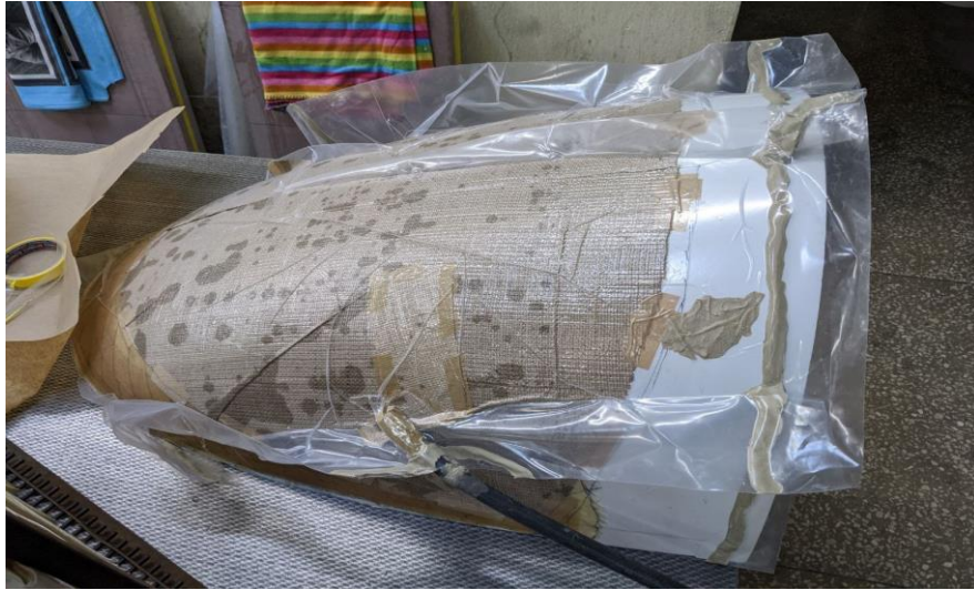
Рис.2.13 – деталь з матрицею в правильному вакуумі
