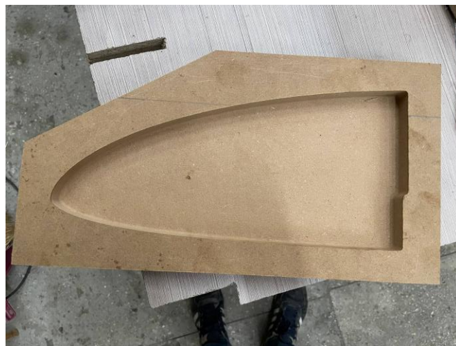
Рис.2.11 – МДФ-пластина після фрезерування
