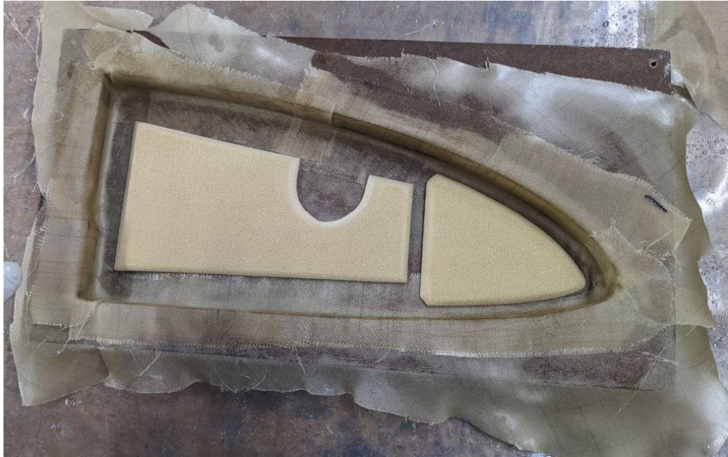
Рис.2.16 – посилення майбутньої деталі шляхом додавання в сендвіч авіаційного пінопласту
