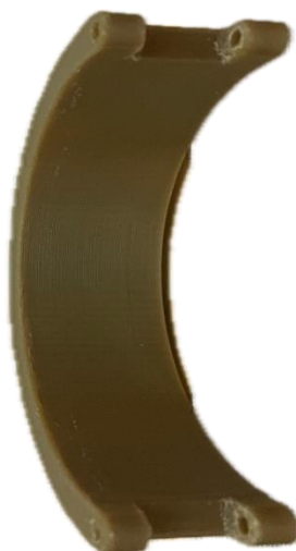
Рис. 2.24 зображення експериментально надрукованого тримача скидального механізму
