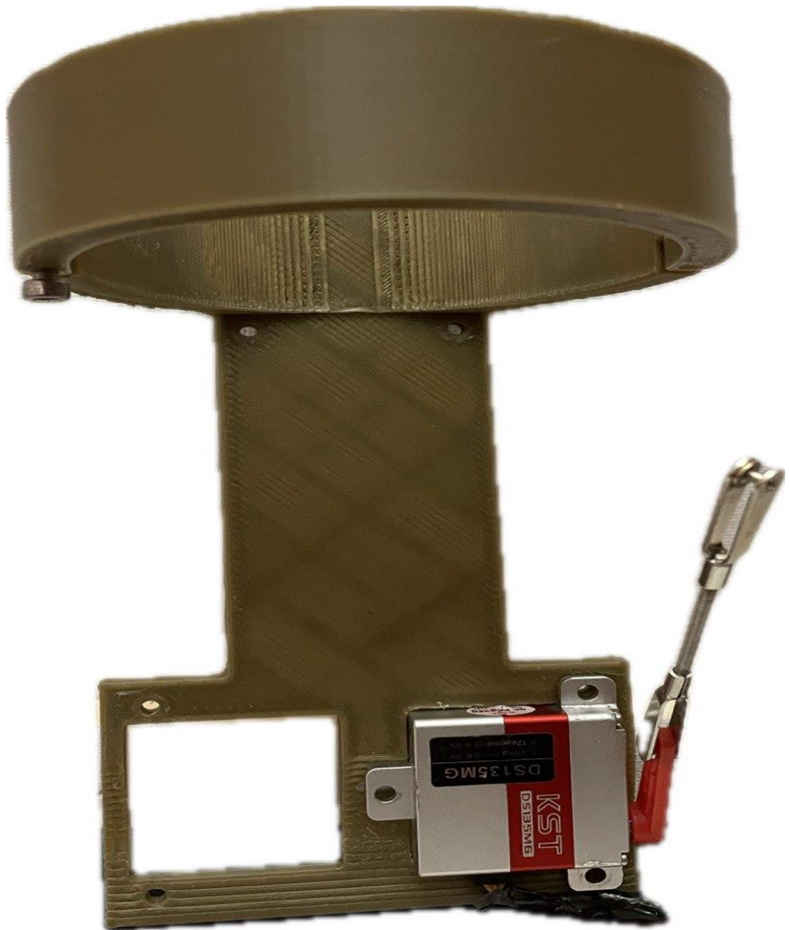
Рис. 2.27 експериментальна модель механізму скидання від низу.
