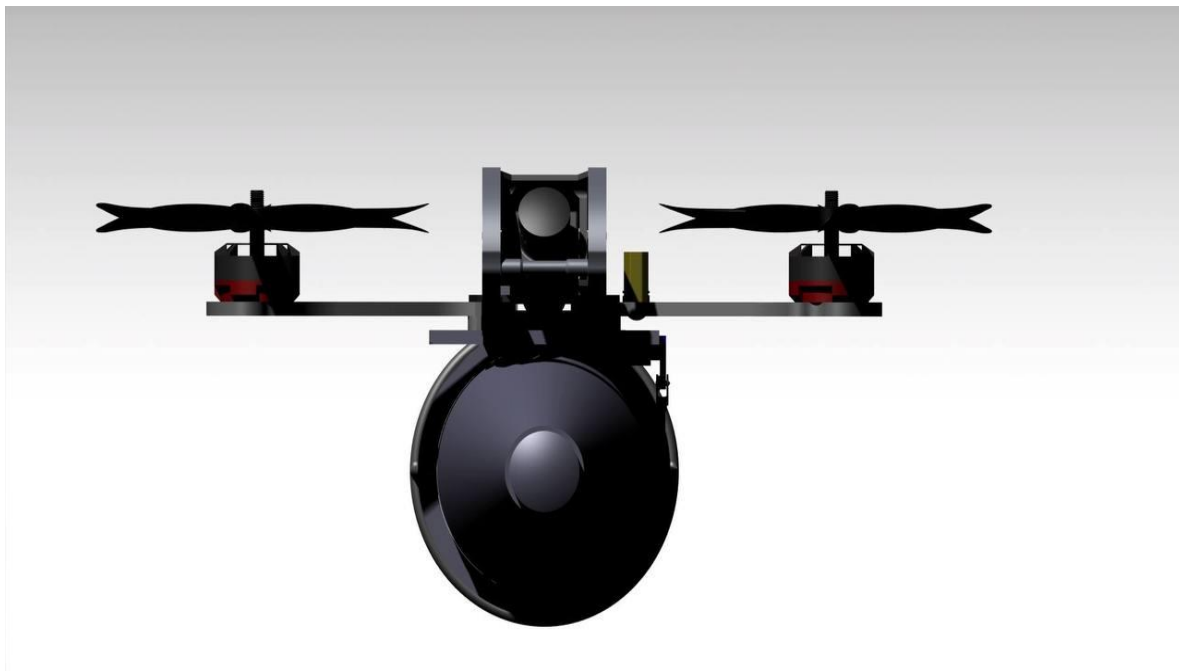
Рис. 2.15 – Скидальний механізм разом з квадрокоптером (люлька закрита)
