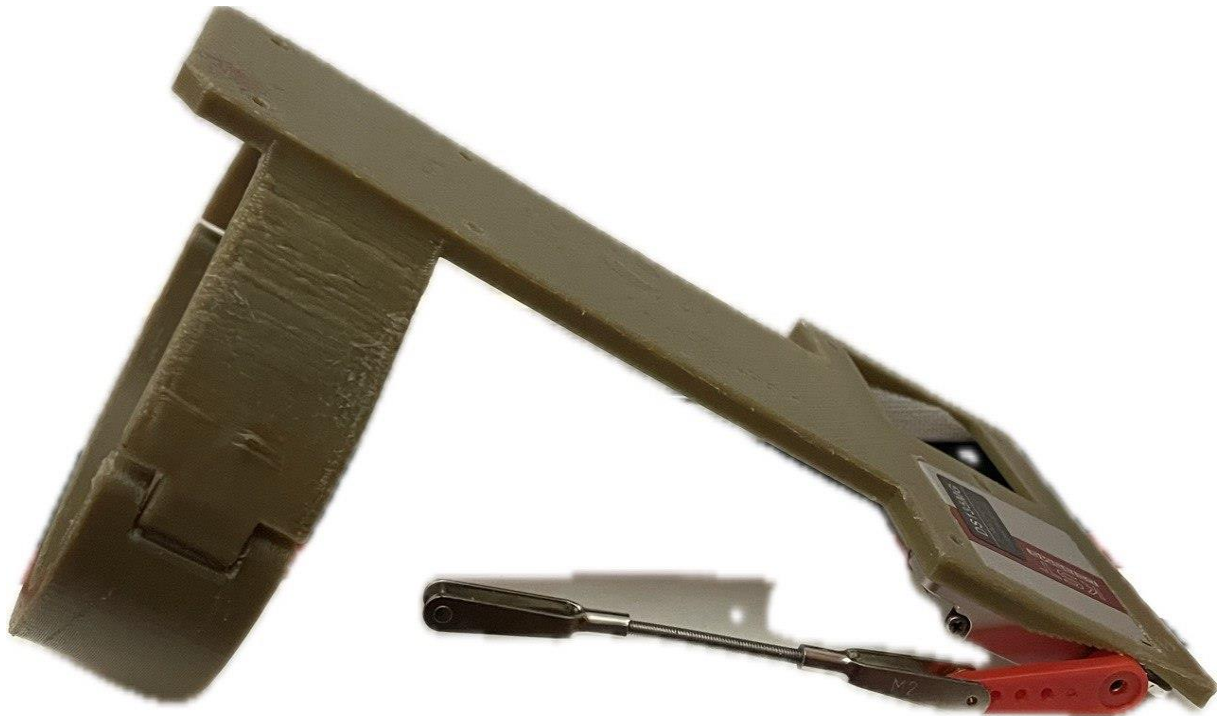
Рис. 2.26 екпериментальна модель механізму скидання вид збоку.
