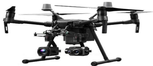
Рис.1.9 DJI Matrice 210 RTK разом зі скидальним механізмом
