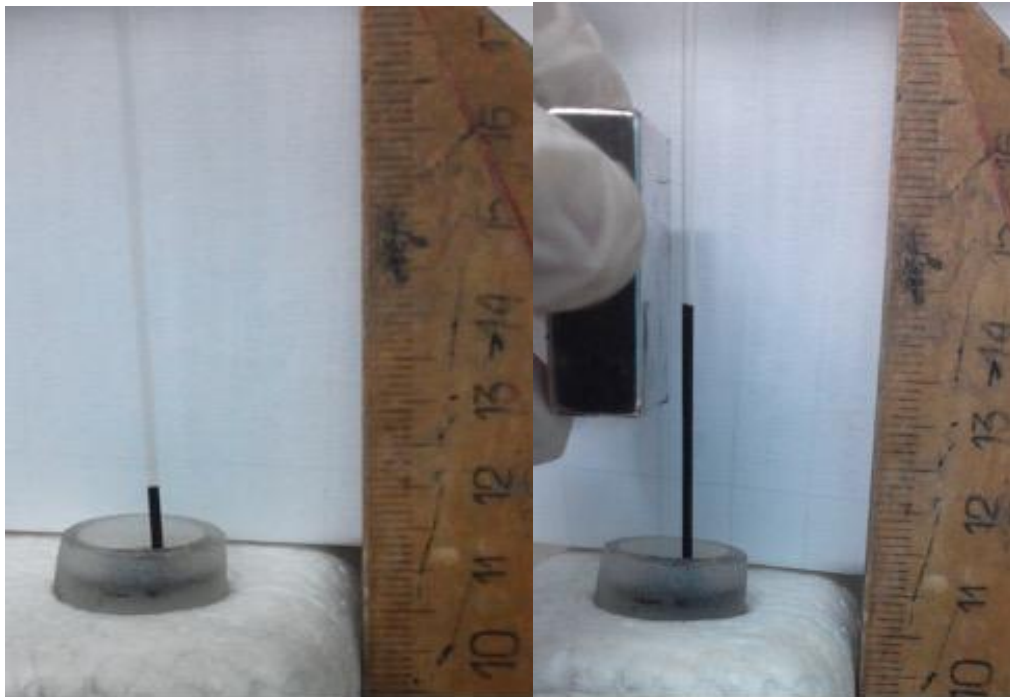
Рис. 4.4 – Заповнення скляного капіляру з магнітно-люмінесцентною композицією (а) – без магніту (б) з магнітом
