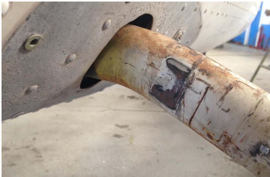
Рис 8.1.1 Корозія опори шасі
