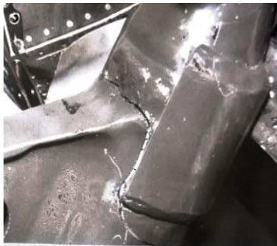
Рис 2.3. Руйнування лівї труби корпусу циліндра при значені N=79870
