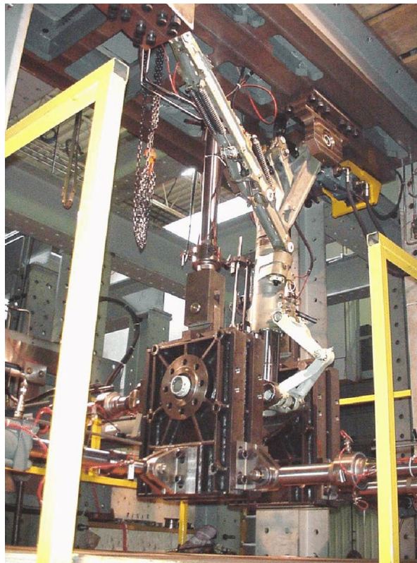
Рис 1.1.2. Ресурсні випробування основної опори шасі Bombardier CRJ 700.
