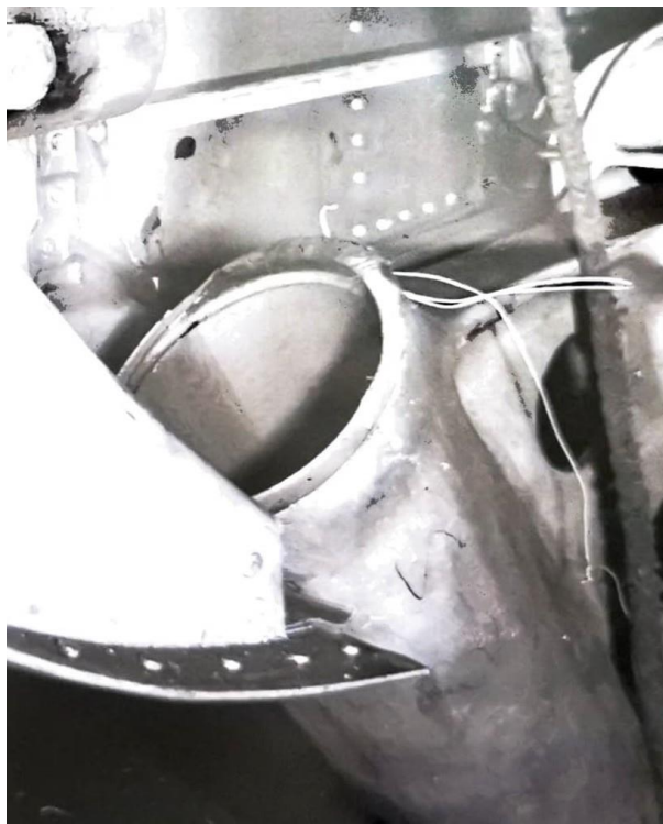
Рис 2.4. Руйнування правої труби циліндра.
