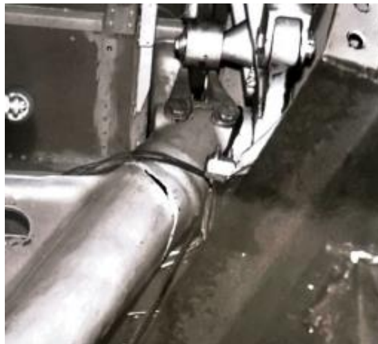
Рис 2.2. Руйнування лівї труби циліндра.
