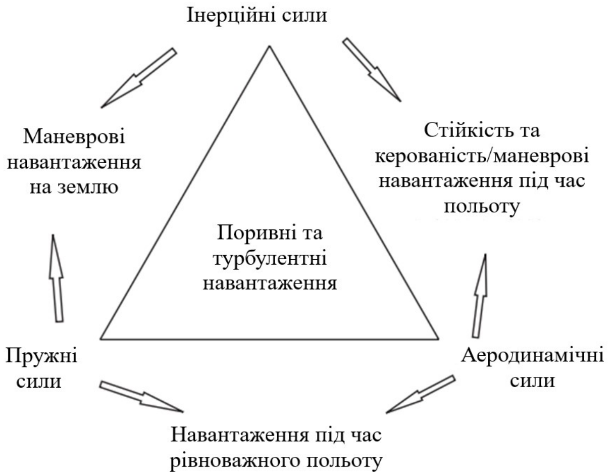
Рис. 1.2. Модифікований аеропружний трикутник.
